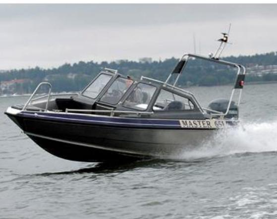
*В кормовом углу по правому борту имеется маленькая «площадка для плавания». По обе стороны рецесса для двигателя имеются ящики, в крышках которых есть «черты ступенек». В ящике левого борта находится топливный фильтр, а в ящике правого борта – аккумулятор и электрический щит. Дуга для установки дополнительного оборудования создает проблемы при входе на катер с кормы.*
